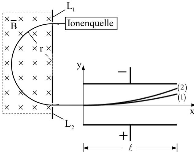
Aus einer Ionenquelle treten einfach positiv geladene Ionen der Lithiumisotope  ${}^6_3\text{Li}$  und  ${}^7_3\text{Li}$  mit unterschiedliche großen Geschwindigkeiten aus. Diese Ionen treten durch eine Lochblende  $L_1$  in ein homogenes Magnetfeld mit der zeitliche konstanten Flussdichte  $\vec{B}$  ein. In diesem Magnetfeld werden die Ionen so abgelenkt, dass sie einen Halbkreis durchlaufen. Ionen, die durch die Lochblende  $L_2$
