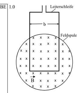
Eine Feldspule hat 16000 Windungen, die Länge  $\ell_F = 60\,\mathrm{cm}\,\mathrm{und}$  einen Querschnitt von  $A = 64\,\mathrm{cm}^2$ . Durch die Feldspule fließt ein konstanter Gleichstrom der Stärke  $I_F$ .
