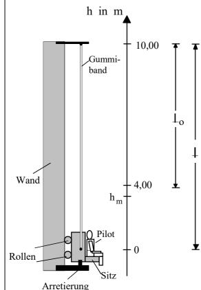
Ein Sitz, der auf Rollen eine Wand hoch laufen kann, ist am unteren Ende eines Gummibandes befestigt. Im unbelasteten Zustand besitzt das Gummiband die Länge  $\ell_0 = 6,00 \text{ m}$ .
