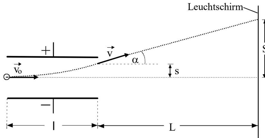
Die negativ geladenen Teilchen ( Masse  $m$ ; Ladung  $q$  ) gelangen in das homogene elektrische Feld eines Plattenkondensators, dessen quadratische Platten die Kantenlänge  $\ell = 4,0\text{ cm}$  haben. Die Eintrittsgeschwindigkeit  $\vec{v}_0$  ist senkrecht zu den Feldlinien gerichtet. Die elektrische Feldstärke  $\vec{E}$  ist zeitlich konstant und beträgt  $E = 3,40 \cdot 10^3 \frac{\text{V}}{\text{m}}$ .
