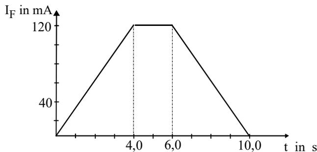
Die Induktionsspule ist vollständig in das Magnetfeld der Feldspule eingetaucht. Die Stromstärke  $I_F$  in der Feldspule hat den in der nebenstehenden Skizze dargestellten zeitlichen Verlauf.
