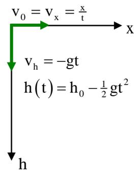
Diese Gleichung nennt man die Bahnkurve eines Körpers, sie beschreibt seine Flugbahn in einem x-h-Diagramm. Bei der Flugbahn handelt es sich um ein „Ast“ einer nach unten geöffneten Parabel.
