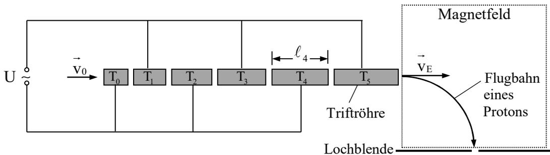
Die oben stehende Skizze zeigt das Schema eines Linearbeschleunigers für Protonen. Der Linearbeschleuniger besteht aus einer Reihe von röhrenförmigen Elektroden (siehe *Triftröhren*  $T_0, T_1, \dots$ ), die mit den Polen eines Hochfrequenzgenerators verbunden sind, dessen Wechselspannung  $U$  den Scheitelwert  $\hat{U} = 0,80 \text{ MV}$  und die Frequenz  $f = 50 \text{ MHz}$  hat.
