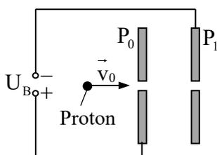
Zwischen den Platten  $P_0$  und  $P_1$  eines Kondensators liegt die Spannung  $U_B = 0,80 \text{ MV}$ . Durch ein kleines Loch in der Platte  $P_0$  treten Protonen mit der Geschwindigkeit  $\vec{v}_0$ , die den Betrag  $v_0 = 4,8 \cdot 10^6 \frac{\text{m}}{\text{s}}$  hat, in das homogene elektrische Feld des Plattenkondensators ein. Bei der ungestörten Bewegung (Vakuum) durch das elektrische Feld nimmt die kinetische
