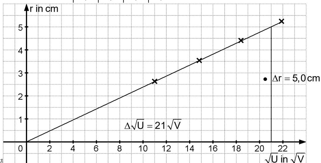
Im Rahmen der Mess- und Zeichengenauigkeit liegen die Punkte auf einer Ursprungshalbgeraden  $\Rightarrow r \sim \sqrt{U}$ , für  $B = \text{konst.}$
